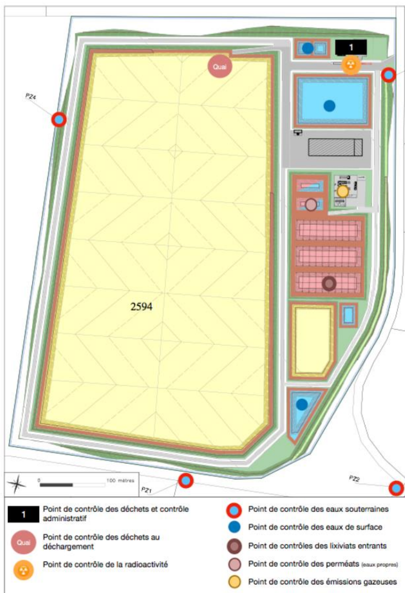
Figure 13. Plan d'implantation de l'ensemble des points de contrôle de l'installation (Source : BETA – Dossier technique)
